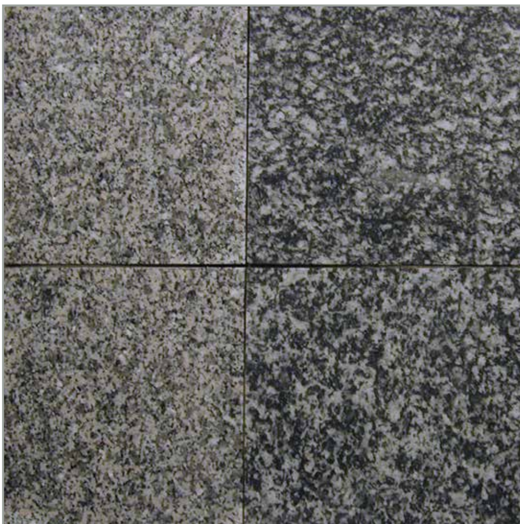
Samma sten lagd med en vanlig fästmassa till höger och med N 23 W till vänster.
