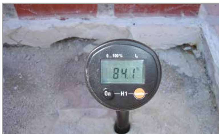
Många fukt känsliga naturstenar kan läggas när fuktinnehållet är nere på 80% RF i underlaget.
